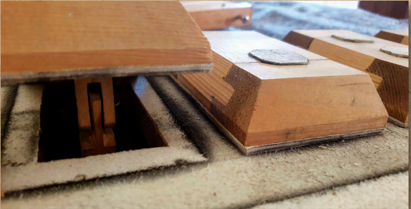
Registerventile, diese werden von den darunterliegenden Pulpeten angehoben
