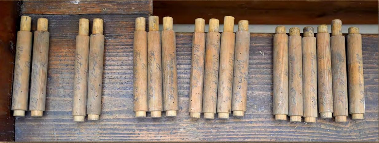
neue Beutelpulpeten (Dichtungen) aus Lammleder am Hauptwerk
