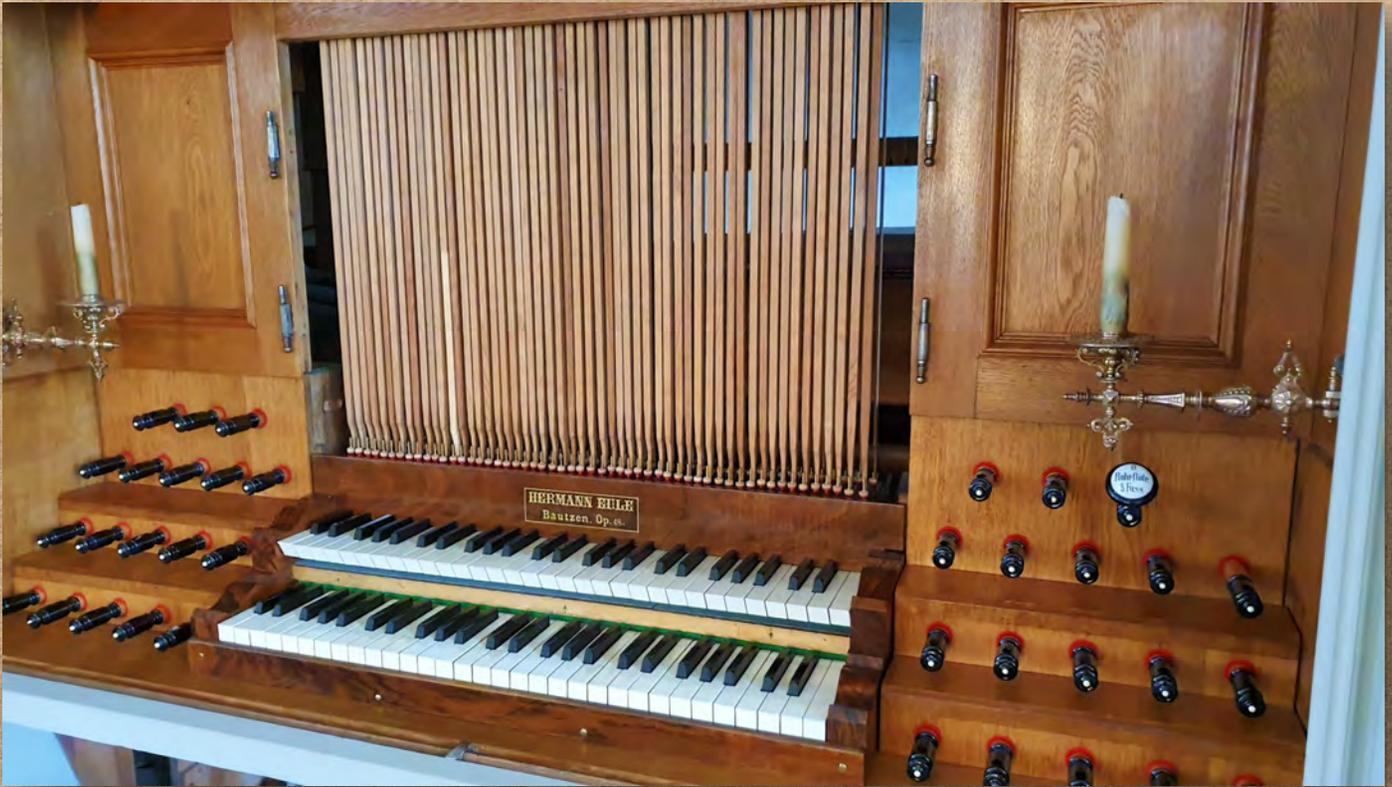
Manual- und Grundgerüst (Winkelbalken mit Schmetterlingslederstücken aus Rindsleder zur Geräuschdämpfung) der Pedalklaviatur sind bereits wieder in die Orgel eingebaut worden. So gewinnt das Äußere des Prospektes wieder den sichtbaren Charakter eines Instrumentes und lässt auf die zu erwartenden Klänge neugierig werden.
