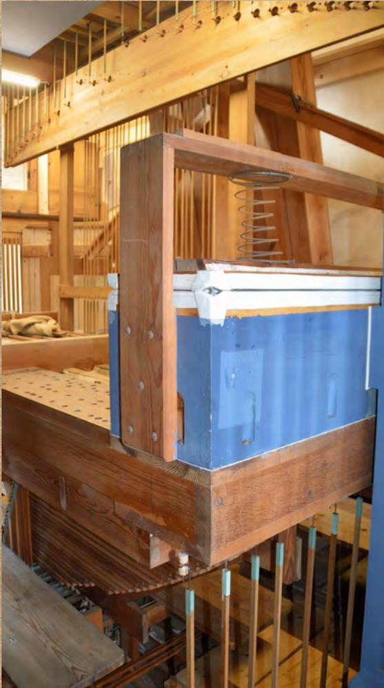
Die Orgel wurde ursprünglich von 5 Kastenbälgen aus mit Wind versorgt. Später ist ein motorbetriebener Blasebalg eingebaut worden. Mit der Sanierung soll die Windversorgung der Orgel wieder über die Kastenbalganlage erfolgen - jedoch nun mit elektronisch gesteuerten Motoren. - Bei Bedarf kann die Orgel auch ohne Strom mit Muskelkraft durch Kalkanten spielfähig gehalten werden.
